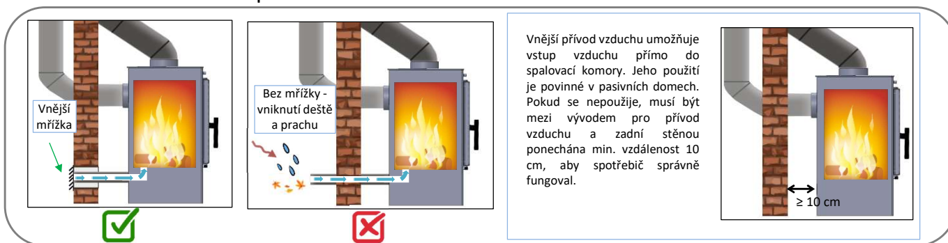
7°.- Instalace externího přívodu vzduchu
