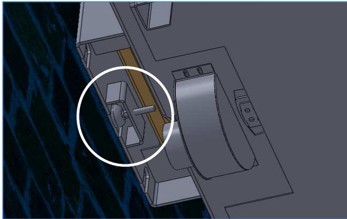
Obrázok 7. Umiestnenie regulačného zariadenia
